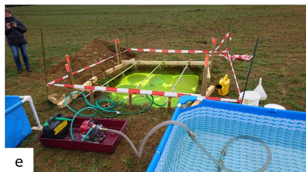
Annexe 14 : Injection de l'uranine et de la sulforhodamine B lors de l'essai de traçage le 16 avril 2019.
