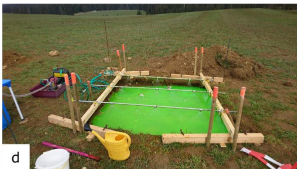
Annexe 14 : Injection de l'uranine et de la sulforhodamine B lors de l'essai de traçage le 16 avril 2019.
