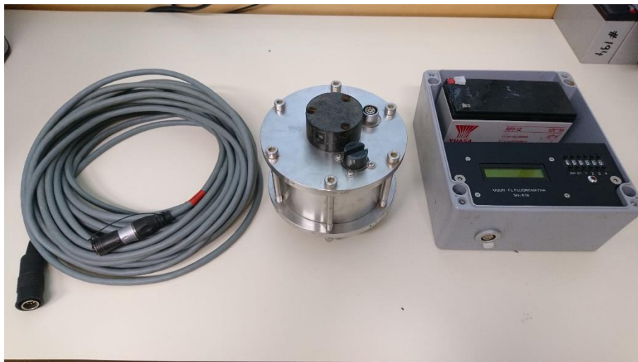
Figure 27: Spectrofluorimètre de terrain GGUN-FL30, à droite le lecteur de données avec batterie, au milieu la sonde et à gauche le câble de connexion.
