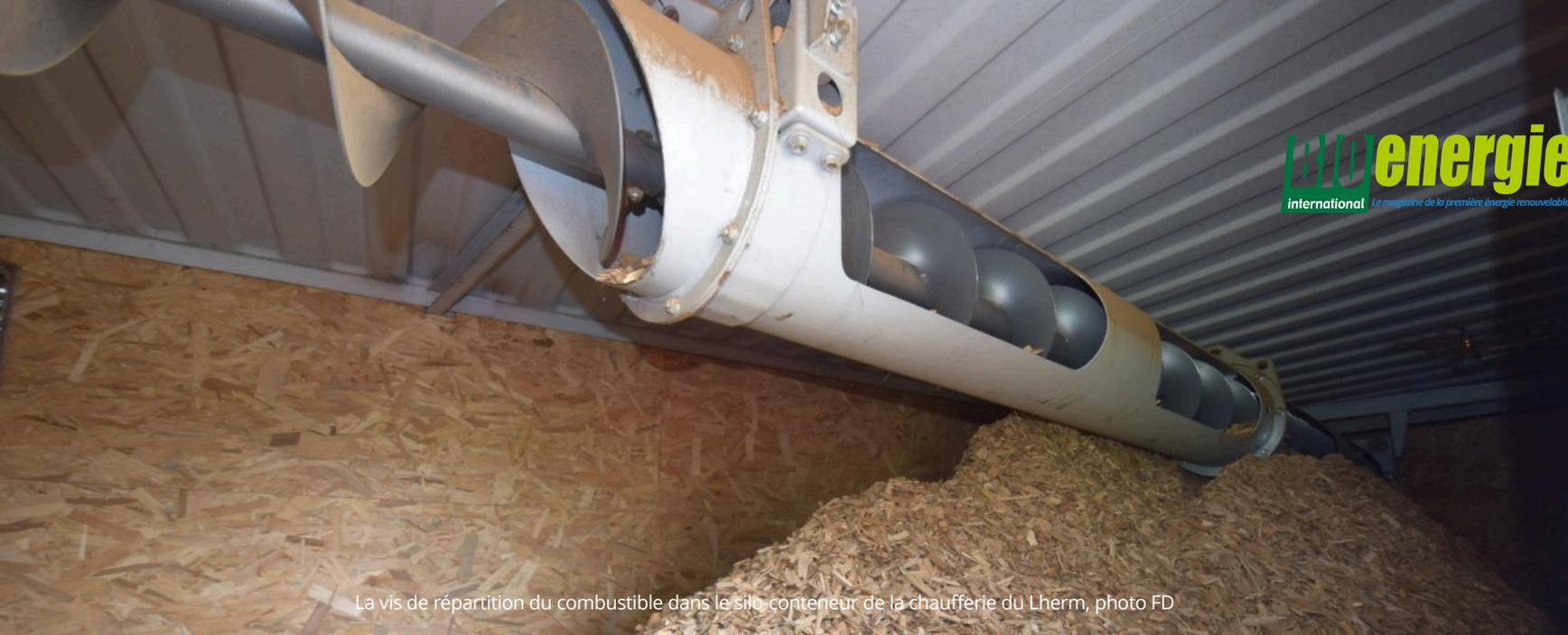
La vis de répartition du combustible dans le silo-conteneur de la chaufferie du Lherm, photo FD
